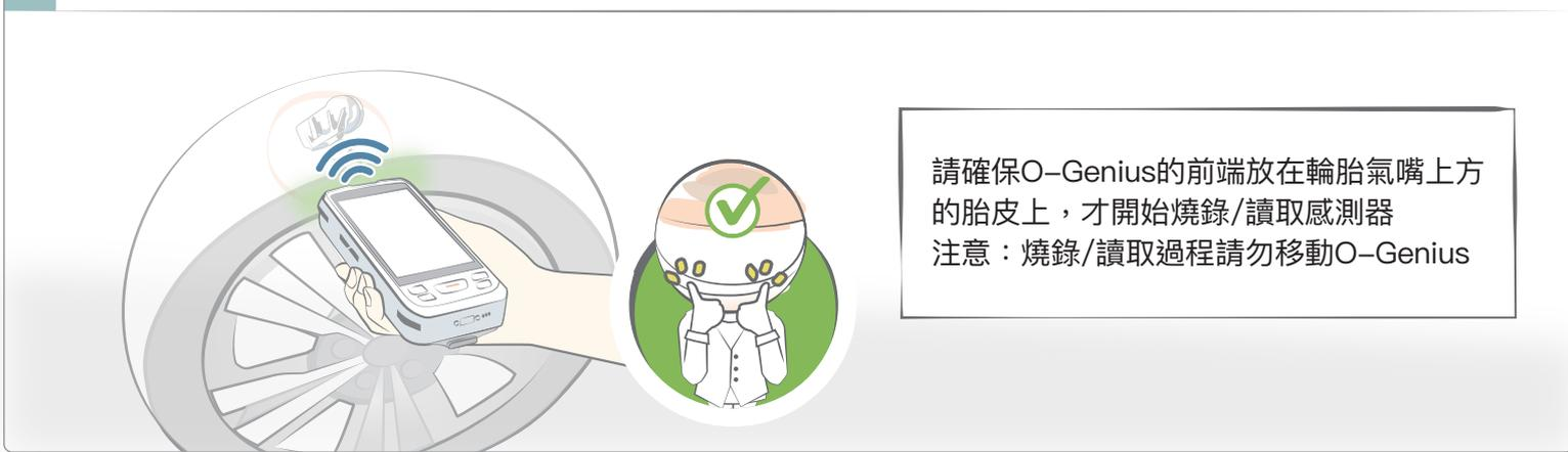
請確保O-Genius的前端放在輪胎氣嘴上方的胎皮上，才開始燒錄/讀取感測器
