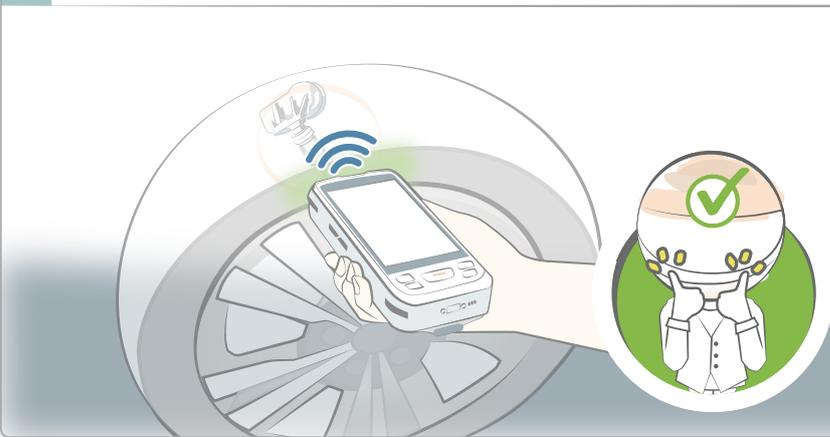
Zum Programmieren, platzieren Sie die Oberseite des O-Genius an der Seitenwand des Reifens auf Höhe des Ventils.
